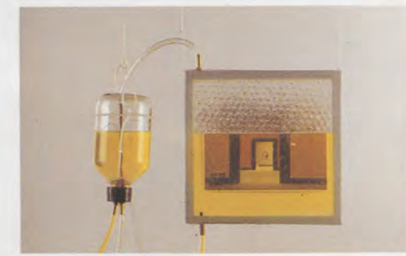
Jurgen Bey Verandering van transparantie. Instroming van vloeistof heft het effect van de glasstructurering op. Proefopstellingen. Change in transparency. Inflowing liquid eliminates the effect of the structured glass. Test set-up.
