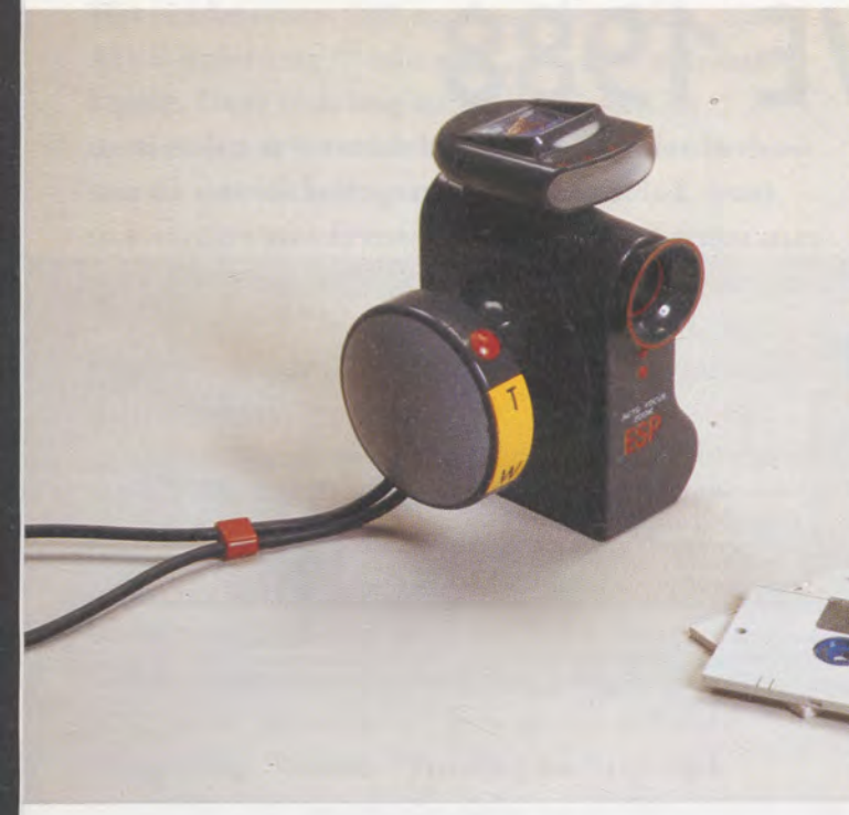
Mark van Tilburg: Concept voor een "4de generatie" ESP-camera (Electronic Still Picture) met 2" floppy-disk als beelddrager. Concept for a "4th generation" Electronic Still Picture (ESP) camera, with a 2" floppy disc as the image carrier.
