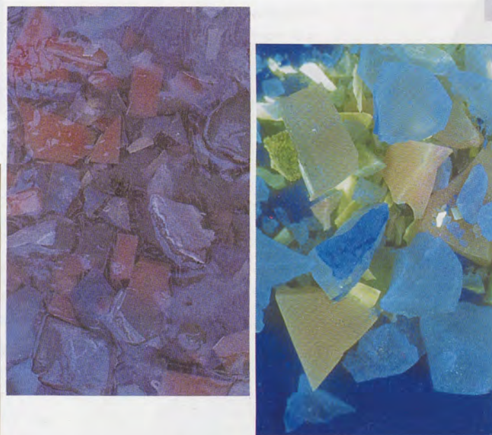
Marjan de Groot: Toepassingsmogelijkheden van fosforescerende materialen in interieurtegels. Afgebeeld: links bij daglicht, rechts onder UV-licht. Possibilities for using phosphorescent materials in interior tiles. Left: in daylight, right: in UV light.
